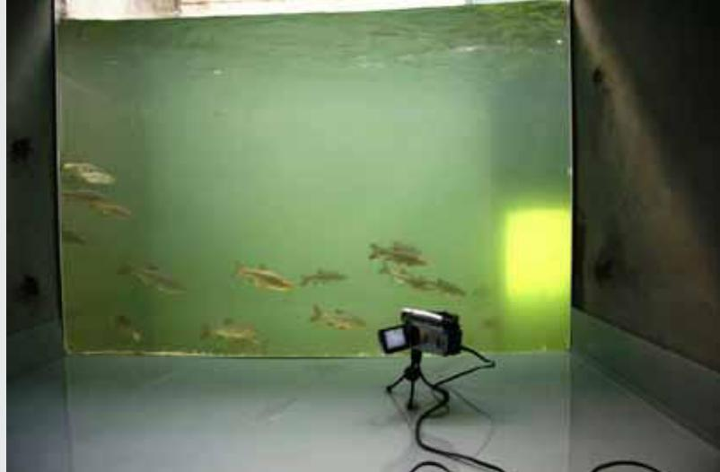
*Monitoraggio della funzionalità del passaggio con telecamera connessa a PC.*
