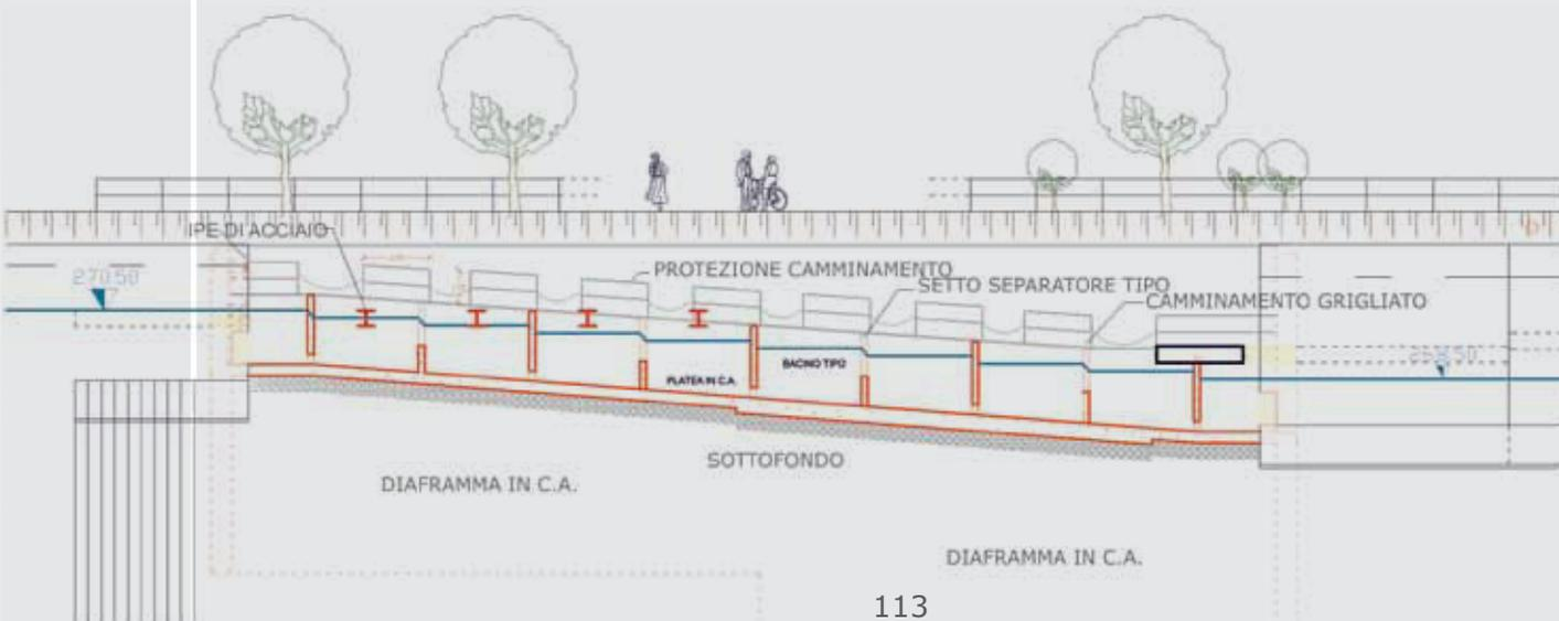
2. i livelli di monte e di valle e il numero di bacini sono stati definiti al fine, in primo luogo, di evitare la formazione di eccessivi dislivelli idrici tra i bacini, la messa in asciutta del passaggio, la formazione di discontinuità insormontabili per i pesci;
